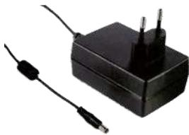
18W Steckernetzteil Eingangsspannung 85V..264V AC, Ausgangsspannung: s. Auswahlbox, Energieeffizienz Level VI, Standby Verbrauch < 0.075W, Schutz gegen Kurzschluss, Überlast, Überspannung. Kunststoffgehäuse, Power ON LED, Betriebstemperatur -30°C ... +70°C (>50°C derating), relative Luftfeuchtigkeit 20% .. 90% nicht kondensierend, Abmessungen LxBxH 79x54x33mm. Innerer kontakt = +.
