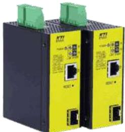
Managed Industrial Ethernet Medienkonverter mit 1x 10/100/1000MBit/s 1000Base-T RJ-45 Port und 1x 100/1000MBit/s 1000Base-X / 100Base-TX Dual Speed SFP Steckplatz für Multimode oder Singlemode (Monomode) SFP Modul. Management via Web, SNMP, VLAN, Jumbo Frames, Power Saving EEE, Hutschienenmontage, erweiterter Temperaturbereich, Betriebsspannung +12V..30V DC, lüfterloses Metallgehäuse, Abmessungen BxTxH 40x80x95mm, Betriebstemperatur -40°C..+75°C, Hutschienenmontage.
