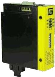
Fast Ethernet Industrie LWL Konverter mit 1x 10/100MBit/s 100Base-TX RJ-45 Port und 1x 100Base-FX Multimode, Singlemode (Monomode) oder Singlemode BiDi (WDM / SingleFiber) LWL Port für ST / BFOC oder SC Steckverbinder. 35mm DIN Hutschienenmontage, lüfterloses Metallgehäuse Abmessungen 28x82x95mm (BxTxH), Betriebsspannung 7V..30V DC, Betriebstemperatur -20°C..+70°C, RH 5%..95% nicht kondensierend, FCC Class A, CE/EMC Class A, EN60950 safety.
