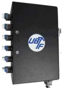
LWL Verteiler Box zur Montage im Schaltschrank auf 35mm DIN Hutschiene (DIN Rail TS-35), konfektioniert mit 12 Fasern, 1x MTP/MPO zu 6x LC duplex Multimode oder singlemode (monomode). Fertig konfektioniert als plug-and-play Installation ohne Spleiß s. Auswahlbox.
