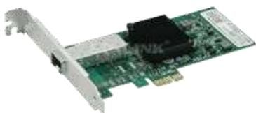
Gigabit Ethernet SFP Server Adapter für die performante Anbindung von Servern an ein Gigabit Ethernet LWL Netzwerk. Features: PCI Express\* Gen 2.1 5GT/s, iSCSI, Intel® VT-c, QoS, PCI-SIG SR-IOV, FPP, TCP Segmentation Offload, Checksum Offload, IEEE802.3az Energy Efficient Ethernet (EEE), DMA Coalescing, VMLB, 802.1q VLAN Support, APM, ACPI v2.0c, MCTP. Stromverbrauch typisch 6W, Betriebstemperatur 0°C..55°C, RH max. 90% nicht kondensierend bei 35°C.
