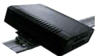
10/100MBit/s 100Base-TX Fast Ethernet Power over Ethernet Injektor mit internem Netzteil 100..240V AC Eingangsspannung (typisch 120V/230V AC), incl. EU Power Cord, PoE Ausgang nach IEEE 802.3af Standard, Betriebstemperatur 0..+60°C für den Betrieb von PoE Endgeräten wie IP Telefone, Wireless Accesspoints oder IP Kameras mit PoE Eingangsversorgung oder über einen PoE Splitter. Industrietauglich. Optional mit 35mm DIN Hutschienenbefestigung (siehe Auswahlbox).
