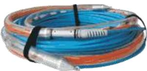
Robustes LWL Bündelader Innenkabel / Außenkabel LSZH mit Nagetierschutz und Längs- und Querwasserschutz für Indoor und Outdoor Verlegung, U-DQ(ZN)BH, Auftragskonfektion Multimode OM2, OM3, OM4 oder Singlemode (Monomode) OS2 mit Steckern Ihrer Wahl, optional einseitig oder beidseitig mit Zug- und Schutzelement. Hutschienenmontage bei Verwendung von MPO/MTP Steckverbindern in Verbindung mit Artikelgruppe 12012062 möglich. Für Erdverlegung oder erhöhtem UV-Schutz siehe Artikel 018600002.
