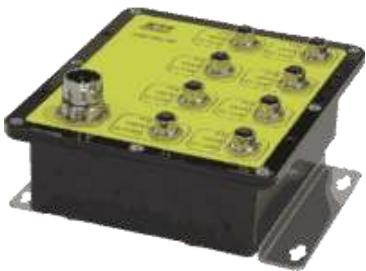
Industrial Fast Ethernet Switch mit 8x 10/100MBit/s 100Base-TX Fast Ethernet Ports für M12 Steckverbinder D kodiert. Betriebstemperatur -40°C..+70°C, Abmessungen 163x195x60.5mm (BxTxH), Schutzart IP65 und IP67, Betriebsspannung +6.5..60V DC an M23 Steckverbinder, Verbrauch: 11.5W, Einbaumontage oder Wandmontage, inklusiver Starter Kabelset.
