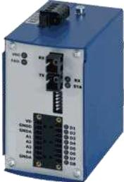
Analoge LWL Bridge für bis zu 4 analoge 0..20mA Stromschnittstellen über eine LWL Verbindung. Wellenlänge 1310nm, Steckverbinder ST/BFOC, SC oder E2000, Abmessungen BxHxT 60x100x113mm ohne LWL Anschluss und Klemmleisten, Betriebstemperatur SC oder ST/BFOC -40°C..+70°C (siehe Auswahlbox), Betriebsspannung 12V..30V DC. Auf Anfrage Betriebsspannung bis 70V DC oder Reichweiten bis 100km möglich.
