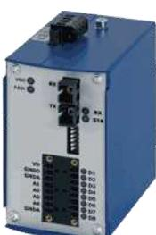
LWL Bridge für digitale IO Schaltsignale, 4x senden 12V - 24V DC, 4x empfangen Relaiskontakt Ausgang. Glasfaser Link Wellenlänge 1310nm. Signal: Input (senden) 12V - 24V DC / 5mA, Output Relais. Betriebsspannung 12V - 30V DC, Verbrauch 5W, Potenzialtrennung 500V DC, Betriebstemperatur -40°C - +70°C, Fehlerrelais Ausgang 25V DC 1A, Gehäuse Edelstahl pulverbeschichtet, Abmessungen HxBxT 115x61x113mm.
