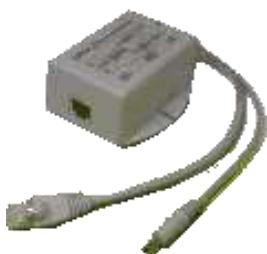
PoE Power over Ethernet Splitter für 1000Base-T High-PoE (PoE+) Anwendungen nach IEEE 802.3at und IEEE 802.3af. Eingang: 40..60V DC PoE, Ausgang: 25W, Ausgangsspannung siehe Auswahlbox, für Gigabit Ethernet 10/100/1000MBit/s. Abmessungen: 85x76x36 mm, optional zur Befestigung auf 35mm DIN Hutschiene.
