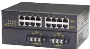
Industrial Power over Gigabit Ethernet Injector mit 8x 10/100/1000MBit/s 1000Base-T RJ-45 PoE Ports nach IEEE 802.3at (max. 30W /Port) und IEEE 802.3af Standard. Lüfterloses Metallgehäuse, Abmessungen BxTxH 190x140x43mm, optional 19" Montagewinkel für 1 oder 2 Geräte lieferbar. Erweiterter Temperaturbereich, Betriebstemperatur -40°C..+70°C. Zulassungen CE mark Class A, FCC Class A.
