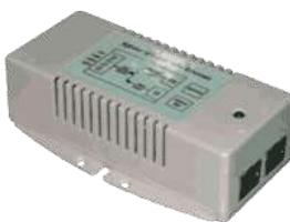
High Power PoE Plus Power over Ethernet Injektor nach IEEE 802.3at Standard 70W mit 1x 10/100/1000MBit 1000Base-T Gigabit Ethernet Port. Eingang an Schraubklemmen siehe Auswahlbox, Ausgang RJ-45 Pins 1236 35W 56V 0.625A und Pins 4578 35W 56V 0.625A, Betriebstemperatur -40°C..+75°C relative Luftfeuchtigkeit 5%..90% nicht kondensierend, Abmessungen 125x72x38mm (LxBxH).
