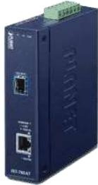
Industrial 10 Gigabit Ethernet Bridging Medienkonverter mit 1x 10G/5G/2.5G/1G/100MBit/s 10GBase-T RJ-45 Port und 1x 10GBit/s 10GbE SFP+ Steckplatz, 16K Jumbo Frame Support, Eingangsspannung 12V .. 48V DC oder 24V AC redundant, Alarmkontakt, 6kV DC ESD Protection, Abmessungen BxTxH 32x87x135mm, Betriebstemperatur -40° .. +75°C, Hutschienenmontage oder Wandmontage.
