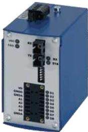
LWL Sender und Empfänger für bis zu 8x 12V - 24V DC digitale Schaltsignale / Steuersignale über LWL Strecken (Multimode oder Singlemode Glasfaser), Betriebsspannung 12V..30V DC, Betriebstemperatur -40°C..+70°C. Montage auf 35mm DIN Hutschiene. Empfänger: separate Spannungs-Eingang für Ausgangssignal mit 500V DC Potenzialtrennung gegen Betriebsspannung. Alternativ Relais-Ausgang.
