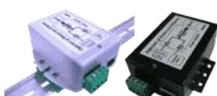
PoE Power over Ethernet Injektor mit 10..36V DC Eingangsspannung, Verbrauch 16.8W max., industrietauglich, erweiterter Temperaturbereich, Abmessungen: 86x76x36mm LxBxH, dual power input. Typisch für Fahrzeuge, Inselsysteme, Batteriebetrieb oder Industrie-Umgebungen mit 12V DC oder 24V DC Versorgungsspannung. Wandmontage, optional mit Hutschienenhalterung zur Montage auf 35mm DIN Hutschiene.
