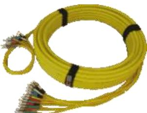
LWL Breakout Kabel (Full Breakout) I-V(ZN)HH. Auftragskonfektion Multimode OM1, OM2, OM3, OM4 oder Singlemode (Monomode) OS2 mit Steckern Ihrer Wahl optional einseitig oder beidseitig mit Zug- und Schutzelement.
