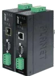
Der Device Server konvertiert RS-232 oder RS-422 / RS-485 COM Ports nach Ethernet TCP/IP und umgekehrt. Seriell: RS-232 an DB9, RS-422/RS485 an Schraubklemmen max. 921600bps, Ethernet: 100Base-TX 10/100MBit/s Fast Ethernet RJ-45 Port oder 100Base-FX 100MBit/s LWL Port, Schutzart IP30, Betriebstemperatur siehe Auswahlbox, Abmessungen WxDxH 135x97x32mm, Eingangsspannung 12..48V DC, Verbrauch 10.1W, Alarmkontakt zur Meldung von Stromausfall, zur Befestigung auf 35mm DIN Hutschiene.
