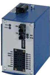
LWL Sender und Empfänger (siehe Auswahlbox) für bis zu 12x 12-24V DC digitale Schaltsignale über LWL Strecken (Multimode Glasfaser oder Singlemode Glasfaser), Signal output 12V .. 24V DC (separate Eingangsspannung). Betriebsspannung 12V..30V DC, Verbrauch 5W, Betriebstemperatur -40°C..+70°C. Gehäuse Edelstahl pulverbeschichtet, Abmessungen HxBxT 100x60x113mm (ohne Steckverbinder).
