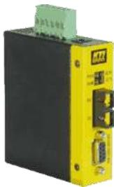
LWL Konverter überträgt RS-232 Signale transparent über Multimode oder Singlemode (Monomode) Glasfaser. D-Sub9 Buchse, DCE, überträgt Handshake (RTS, CTS, DTR, DSR), optical isolation between RS-232 and main circuitry, ESD-Schutz und Überspannungsschutz (RS232), Relais Meldekontakt für Stromausfall, lüfterloses Metallgehäuse, Abmessungen WxDxH 28x82x95mm, Montage auf 35mm DIN Hutschiene, Betriebstemperatur -30..+70°C, Betriebsspannung +7V..+30V DC an Schraubklemme oder DC Buchse.
