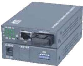
Fast Ethernet Desktop Medienkonverter mit 1x 10/100MBit/s 100Base-TX RJ-45 Port und 1x 100Base-FX Multimode / Singlemode (Monomode) / BiDi (WDM / SingleFiber) Port, Optimiertes Latenzverhalten, auto-negotiation, auto MDI/MDI-X, Abmessungen 108x75.5x23mm, Betriebsspannung +5V..+12V DC, Verbrauch max. 2W. Betriebstemperatur -5°C..+50°C, RH 5..95% nicht kondensierend, FCC class B, CE class B, Remote Port Status (LED), 19" Rack Installation mit Artikelgruppe 0961138 oder 0961398.
