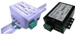
PoE Power over Gigabit Ethernet Injektor für Gleichstrom. Eingang 10..36V DC, Ausgang PoE 17W max. (48V 0,35A) nach IEEE 802.3af Mode A (Pins 12- 36+) oder Mode B (Pins 45+ 78-) s. Auswahlbox, industrietauglich, Abmessungen: 85x57x36mm LxBxH, input with fuse protection, Schutz gegen Kurzschluss, CE, UL1950, CSA 22.2, EN60950-1, FCC Class B, EN55032 Class B, Betriebstemperatur -40°C..+70°C, Wandmontage, optional mit Hutschienenhalterung.
