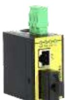
Fast Ethernet Industrie LWL Konverter mit 1x 10/100MBit/s 100Base-TX RJ-45 Port und 1x 100Base-FX LWL Port, optimiertes Latenzverhalten, lüfterloses Metallgehäuse, Montage: DIN Hutschiene oder Wand, 802.1Q VLAN transparent, Betriebsspannung 4.5V..50V DC, optional 110V DC, Abmessungen: 34x48x56mm (BxTxH) (4.5V..50V DC) oder 45.5x49x56mm (BxTxH) (110V DC), Betriebstemperatur: -20°C..+70°.
