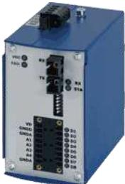
Analoge LWL Bridge für bis zu 4 analoge 0..10V Spannungsschnittstellen über eine LWL Verbindung. Wellenlänge 1310nm, Steckverbinder ST/BFOC, SC oder E2000, Abmessungen BxHxT 60x100x113mm ohne LWL Anschluss und Klemmleisten, Betriebstemperatur -40°C..+70°C, Betriebsspannung 12V..30V DC. Auf Anfrage Versorgungsspannung bis 70V DC oder Reichweiten bis 100km möglich.
