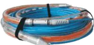
Robustes LWL Bündelader Außenkabel mit Nagetierschutz, Längs- und Querwasserschutz, A-DQ(ZN)B2Y, Auftragskonfektion Multimode OM2, OM3, OM4 oder Singlemode (Monomode) OS2 mit Steckern Ihrer Wahl, optional einseitig oder beidseitig mit Zug- und Schutzelement. Hutschienenmontage bei Verwendung von MPO/MTP Steckverbindern in Verbindung mit Artikelgruppe 12012062 möglich. Für Innenkabel siehe Artikel 018600004.
