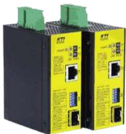
Industrial Ethernet Medienkonverter mit 1x 10/100/1000MBit/s 1000Base-T RJ-45 Port und 1x 100/1000MBit/s 1000Base-X / 100Base-TX Dual Speed SFP Steckplatz für Multimode oder Singlemode (Monomode) SFP Modul. Jumbo Frames, Power Saving EEE, Hutschienenmontage, erweiterter Temperaturbereich, Betriebsspannung +12V..30V DC, lüfterloses Metallgehäuse, Abmessungen BxTxH 40x80x95mm, Betriebstemperatur -40°C..+75°C, Hutschienenmontage.
