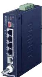
Industrial Ethernet VDSL2 Bridge zur Übertragung von Ethernet Signalen über RJ-11 2-Draht Leitungen (min. AWG-24) oder Koaxial Kabel. Reichweite: Koaxial bis zu 1.2km 2-Draht bis zu 1.2km. LAN: 4x 1000Base-T 10/100/1000MBit/s RJ-45 Ports. Abmessungen: 135x87.8x32mm (HxTxW), Eingangsspannung 12V..48V DC oder 24V AC (max. 0.4A), Stromverbrauch 5.7W, Betriebstemperatur -40°C..+75°C, relative Luftfeuchtigkeit 5%..95% nicht kondensierend.
