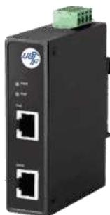
Industrial Power over Gigabit Ethernet Injector, Datenports 10/100/1000MBit/s 1000Base-T RJ-45, Eingangsspannung 12V..55V DC an Schraubklemme, Ausgang nach IEEE 802.3at Standard max. 30W, Verbrauch 1.44W + PoE. Betriebstemperatur -40°C..+85°C, relative Luftfeuchtigkeit 5%..95% nicht kondensierend, robustes Metallgehäuse IP30, Abmessungen BxHxT 26x95x75mm, 35mm DIN Hutschienenmontage und Wandmontage, Overload Current Protection, Reverse Polarity Protection, CE, FCC Class A
