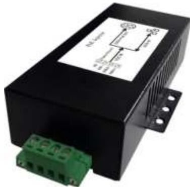
Für die Anbindung von Kameras, Accesspoints und Displays mit Datenraten bis zu 10 Gigabit/s bei gleichzeitiger Versorgung mit bis zu 35W Betriebsstrom über das Datenkabel nach IEEE 802.3at stellt UBF EDV Handel und Beratung Jürgen Fischer GmbH einen PoE Power over Ethernet Injektor vor, der mit seinem DC Weitbereichseingang von 10V DC bis 36V DC auch für Umgebungen mit 12V DC oder 24V DC geeignet ist.
